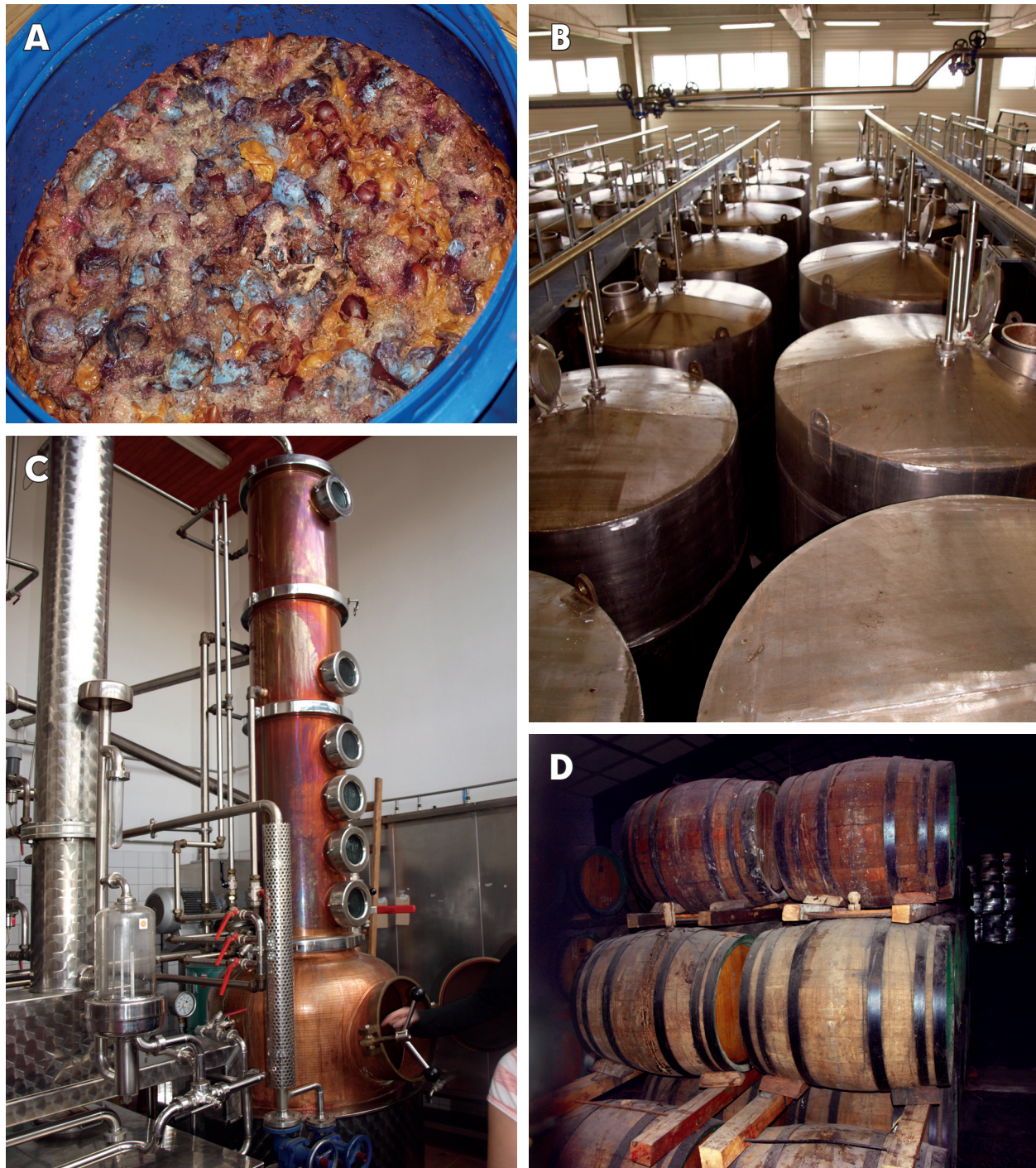
Obrázek 5.3 Výroba ovocných destilátů: (A) plastové kvasné kádě s rozmačkaným ovocem (domácí produkce); (B) velkokapacitní nerezové kvasné tanky; (C) destilační aparatura; (D) některé ušlechtilé destiláty dozrávají v sudech – Distillery Land, R. Jelínek, Vizovice. Foto: B. Mieslerová
