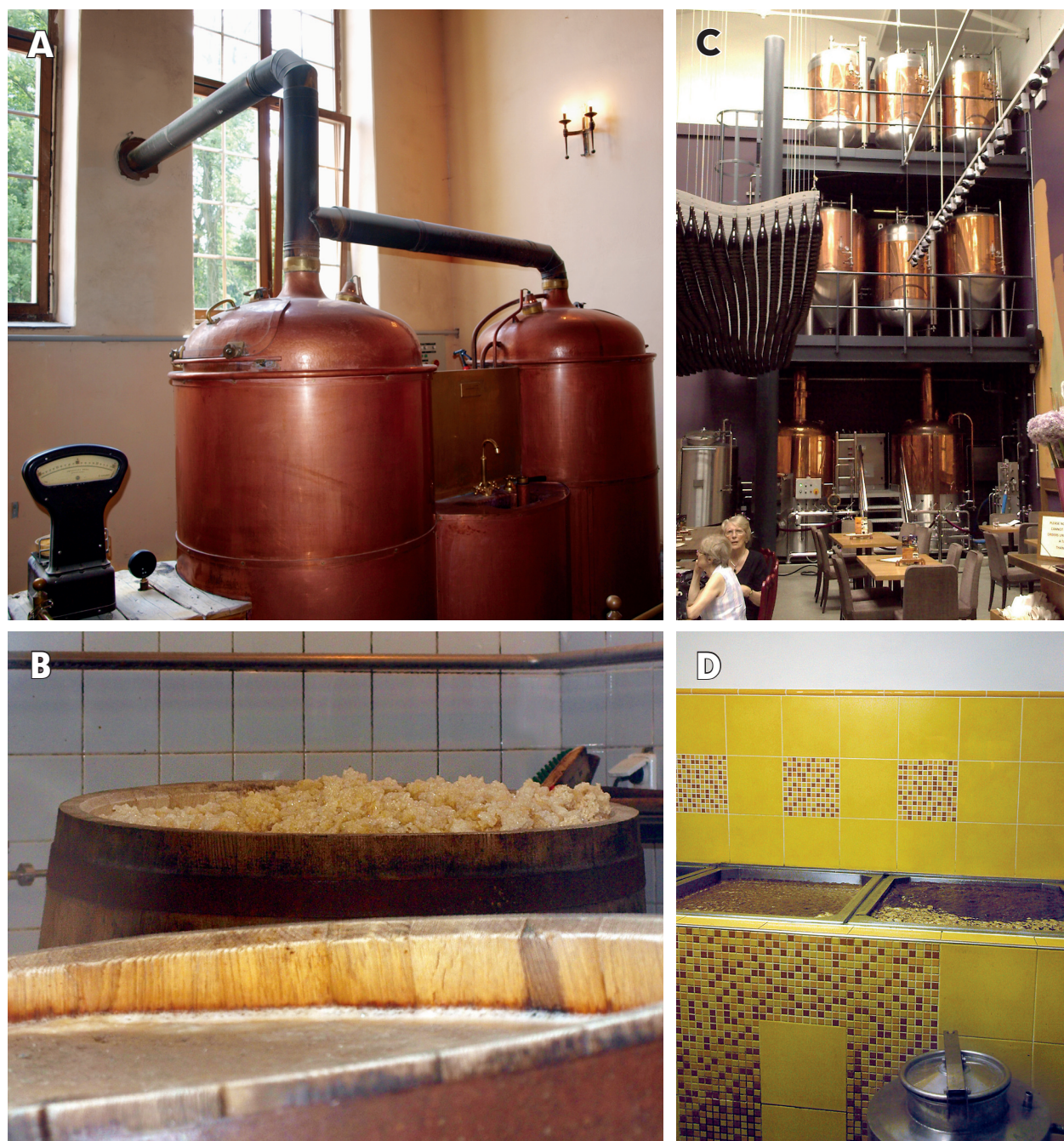
Obrázek 3.4 Minipivovary: (A) tradiční varna pro výrobu mladiny a (B) kvašení piva v kádích – pivovar Dětenice; (C) technologie horké fáze výroby (dole) a dokvašování piva typu „Ale“ (nefiltrované, nepasterované) v tancích přímo v restauraci tzv. „cask conditioned ale“ – The Old Brewery, Greenwich, Londýn; (D) nerezová spilka – minipivovar Moritz, Olomouc. Foto: B. Mieslerová (A, B), M. Sedlářová (C, D)
